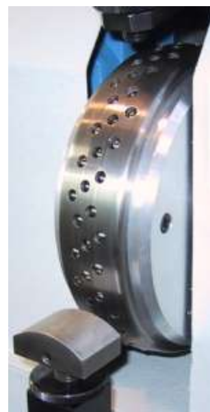
Kugelwalze mit Auflage Walec kulkowy, z podpora
